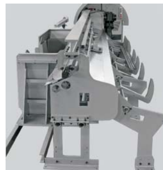
▲ Anbau für beidseitigen Stabausfall
