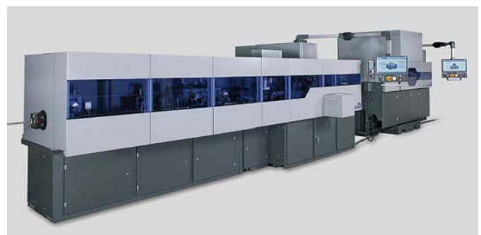
▼ Kettenbiegemaschine KEB 7.2 und Kettenschweißmaschine KEH 7.2
